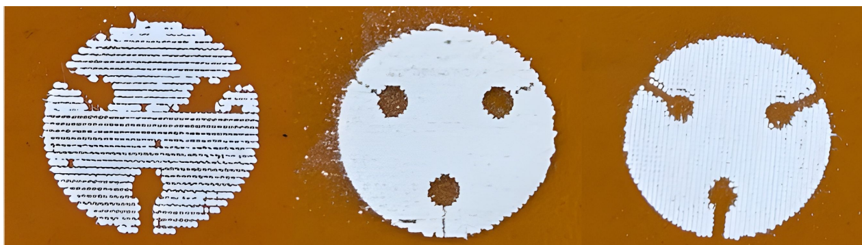
Рис. 2. Вид напечатанного слоя интерконнектора на полиимидной подложке в процессе оптимизации параметров струйной 3D-печати (цвет онлайн)
