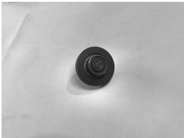
Рис. 1. Изолятор элемента ИСП3-1 для источника тока ФУЛ-600
