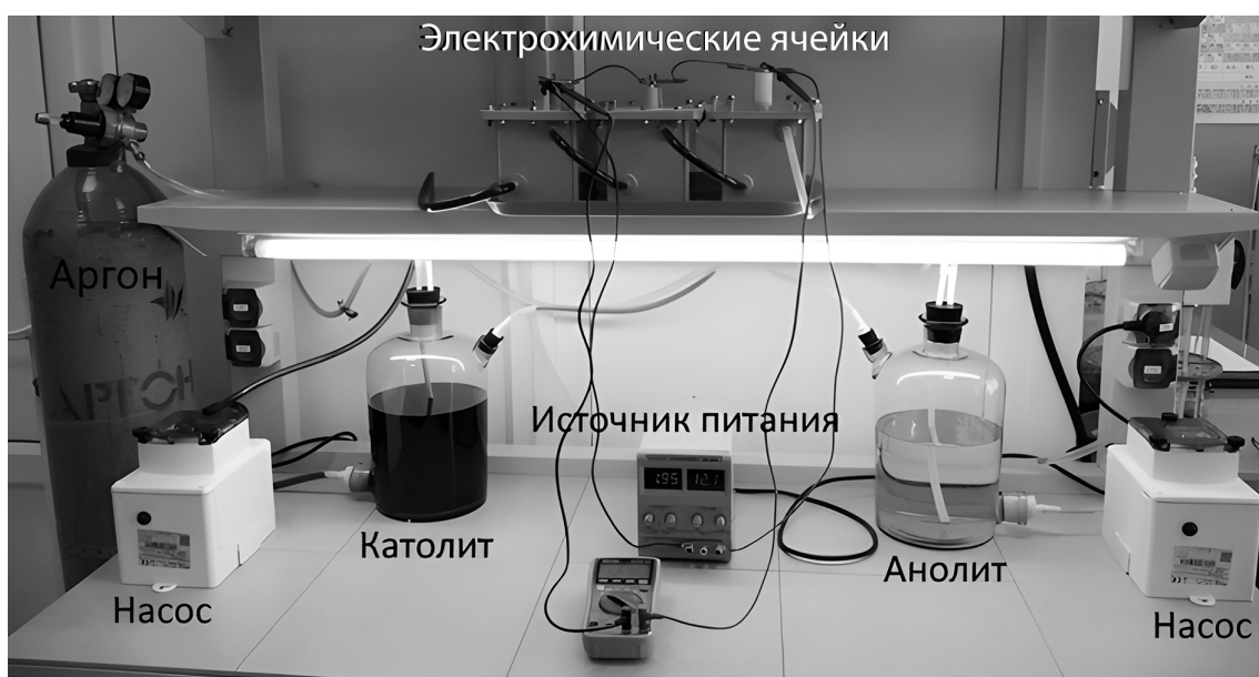
Рис. 11. Лабораторный макет редокс-проточной батареи на основе натриевой соли и антрахинонсульфокислоты (анолит) и ферроцианида калия (католит) в щелочных растворах с тремя рабочими ячейками
